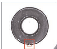
頭裂 Head Crack
